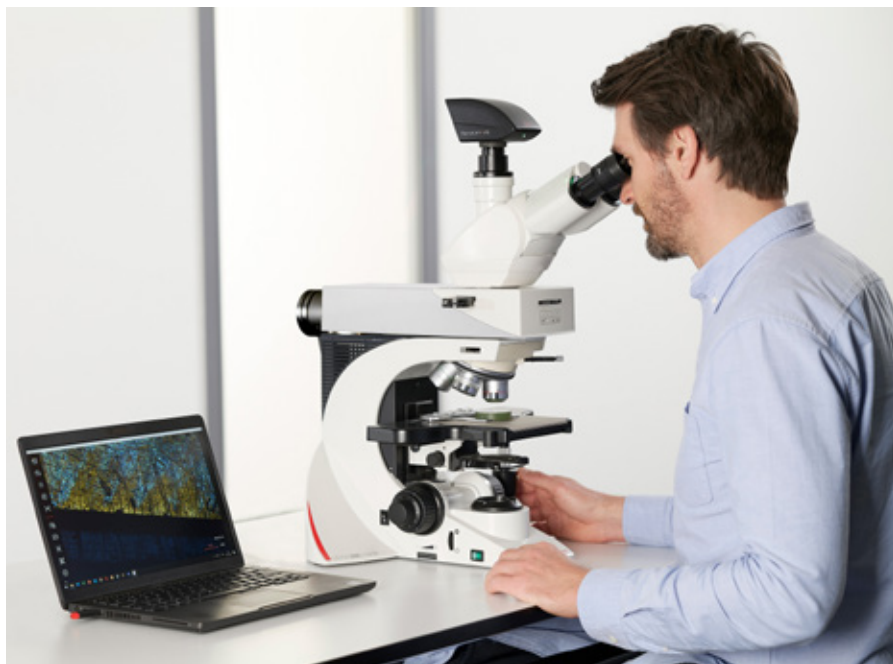
Microscopio composto DM2700 M dotato di fotocamera Flexacam c5 che utilizza l'app per desktop della piattaforma software Enersight.
