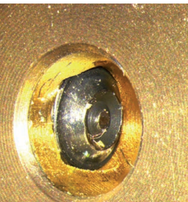
Leica LED5000 NVI: Registrazione interna di un grano filettato in una ruota dentata di ottone
