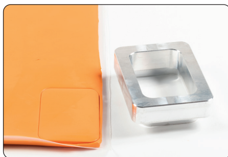
Pressione sul foglio di silicone e taglio. Pressure on the silicone sheet and cut. Pression sur la feuille de silicone et découpe. Presionar la lámina de silicona y cortar.
