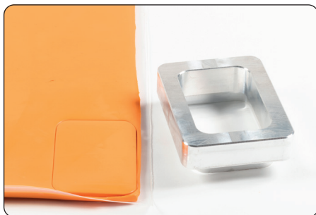
Pressione sul foglio di silicone e taglio. Pressure on the silicone sheet and cut. Pression sur la feuille de silicone et découpe. Presionar la lámina de silicona y cortar.
