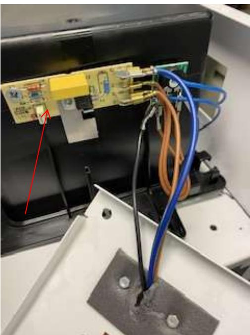
Sostituzione Scheda ELETTRONICA : (LA FOT DELLA SCHEDA E' SOLO DI ESEMPIO – OGNI VERSIONE HA UNA SCHEDA DIFFERENTE ) fare foto dello schema elettrico e colori cavi Per una veloce sostituzione scollegare solo i faston dalla scheda rettangolare.
