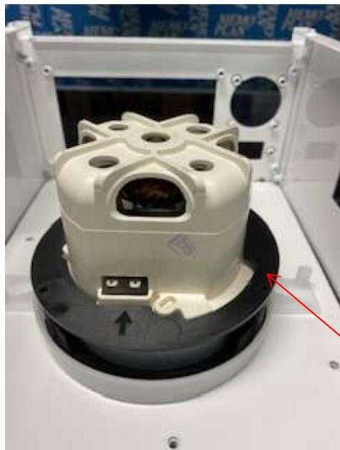
Per sostituire il motore rimuovere I flangia anti rotazione svitando le 4 viti .
